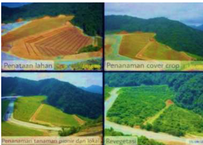
Tahapan Dalam Reklamasi Lahan Bekas Tambang (Mine Out) : 1).Penataan Lahan, 2).Penanaman Cover Crop, 3).Penanaman Tanaman Pionir dan Tanaman Lokal, 4).Revegetasi.
